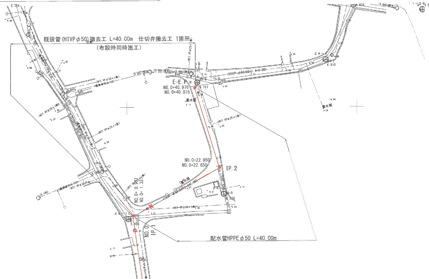
配水管平面図(E路線) S=1:250
